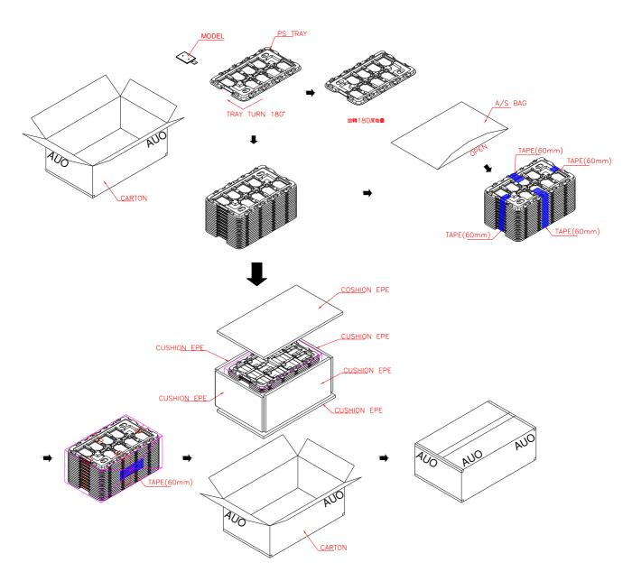
MAX. CAPACITY:160 MODULES MAX. WEIGHT: 12Kg
